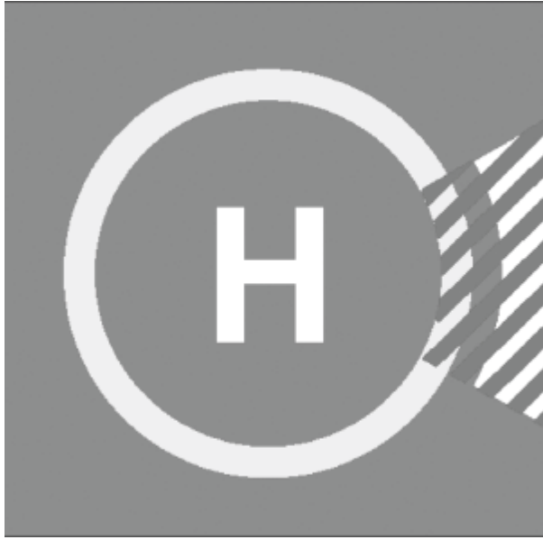
Фиг. 57. Маркировка на сектор за забранено кацане на палубни вертолетни площадки
