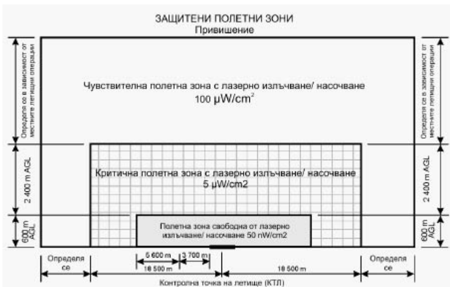
Фиг. 15-2. Полетни зони, свободни от лазерно излъчване/насочване на многопистова система
