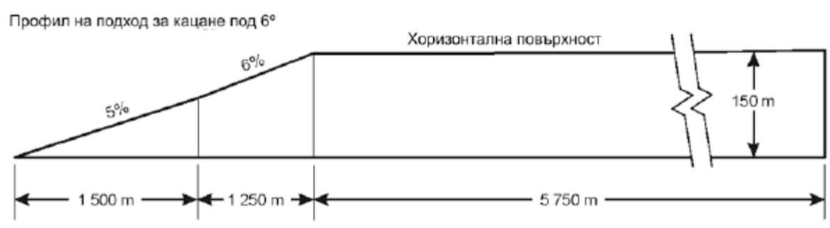
Фиг. 47. Повърхност на подхода за кацане на ФАТО, оборудвана за точен подход за кацане
